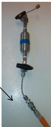
Tuyau d'arrivée d'eau (vannes en position fermée sur cette photo)
